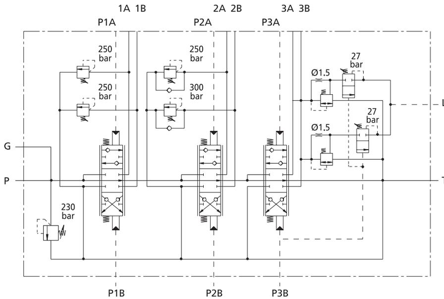
Bom sürgüsünü kontrol etmede kullanılan HPV ve SPV pilot kontrol valferi düşük basınçta POFC'yi aktive eder. Yukarıda gösterilen örnekte, her iki pilot çek valf float durumunda açırken, bir pilot çek valf silindir başı tarafındaki hidrolik yağın tanka dönüşünü sağlamak için "düşük güç" durumda açılır. Ayrıca "X" Veya valfinin takılması, bom sürgüsü kaldırma konumuna getirildiğinde piston rodu tarafındaki hidro yağın tanka dönüşünü sağlamak için pilot çek valflerden birinin kullanılmasını sağlar.
