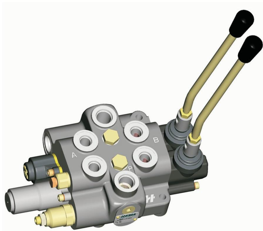
MV051 monoblok yön kontrol valfi özellikle mobil hidrolik uygulamalar için tasarlanmıştır. 50 lt/dak debi geçirgenliğine ve 315 bar'lık servis hattı basınç dayanımına sahiptir.
