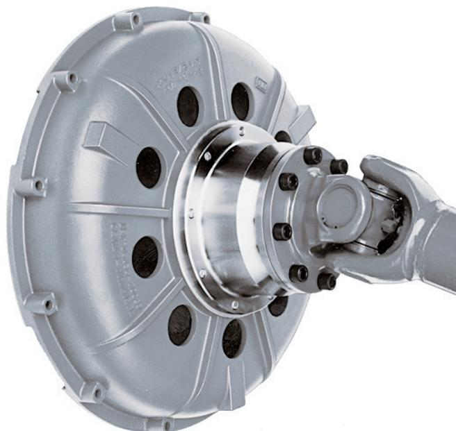
Bekanntlich geben Kardanwellen axiale und radiale Reaktionskräfte ab. Diese sind u.a. abhängig vom übertragenen Drehmoment und von dem Beugungswinkel. Bei größerem Beugungswinkel können diese Kräfte so beträchtlich werden, daß die Lagerung der Kurbelwelle und des Dieselmotors gefährdet ist.
